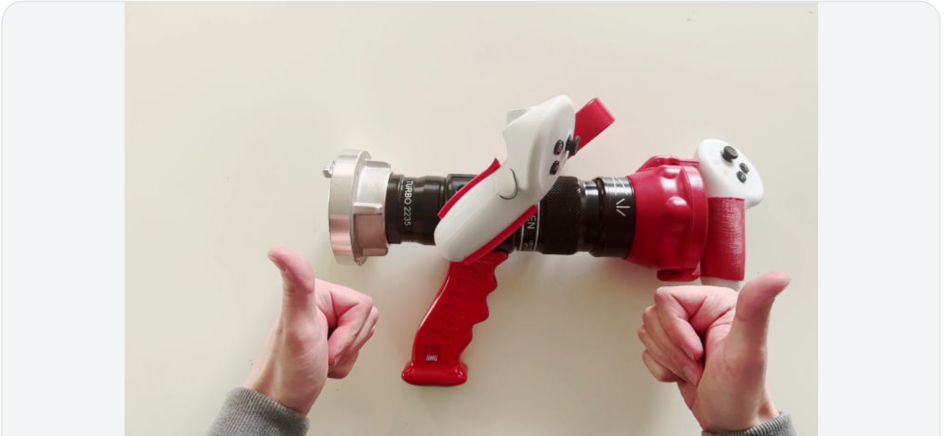
Fertig eingerichtetes Strahlrohr mit beiden eingesetzten Controllern
